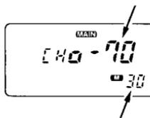
Il display indica che 70 memorie sono allocate alla banda VHF e 30 alla banda UHF.
