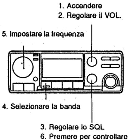
1. Premere il tasto [ON/VOL] in modo da accendere l'apparato, quindi ruotare a fine corsa sinistra il controllo [SQL/MONITOR].
