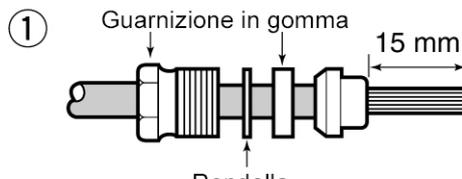
Infilare nel cavo il dado finale, la rondella, la guarnizione di gomma e la ritenuta.
