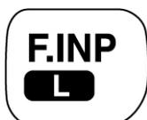
Premerlo per abilitare l’impostazione diretta della frequenza oppure del numero di memoria. Mantenerlo premuto per 0.5s per commutare su ON/OFF il ‘key lock’ ovvero il blocco sui tasti posti sul Remote controller RC-24
