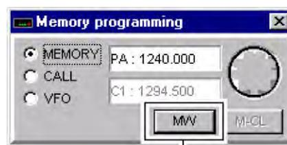
5. Similmente al passo 1) predisporre la frequenza per l'arresto della ricerca equivalente all'altro limite di banda.
