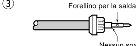
Sul conduttore centrale saldare il pin rispettando le quote come illustrato.
