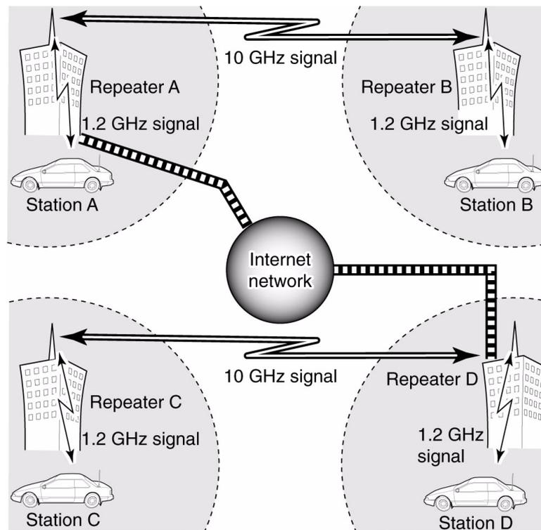
Con il sistema D-Star è possibile l'interlacciamento dei ripetitori nella banda dei 10 GHz in modo da realizzare una dorsale nonché l'allacciamento alla rete Internet (connessione gateway). Cosicché usufruendo della fonia digitale si otterrà una copertura geografica impensabile con i sistemi usati in precedenza.
